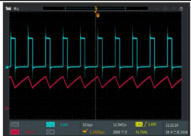
SW 脚与电感电流工作波形
